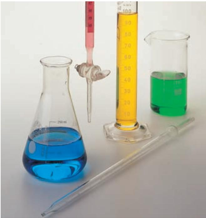
Instrumentos de laboratorio que miden volúmenes de líquidos. De izquierda a derecha, erlenmeyer, bureta, probeta, vaso graduado y pipeta.
